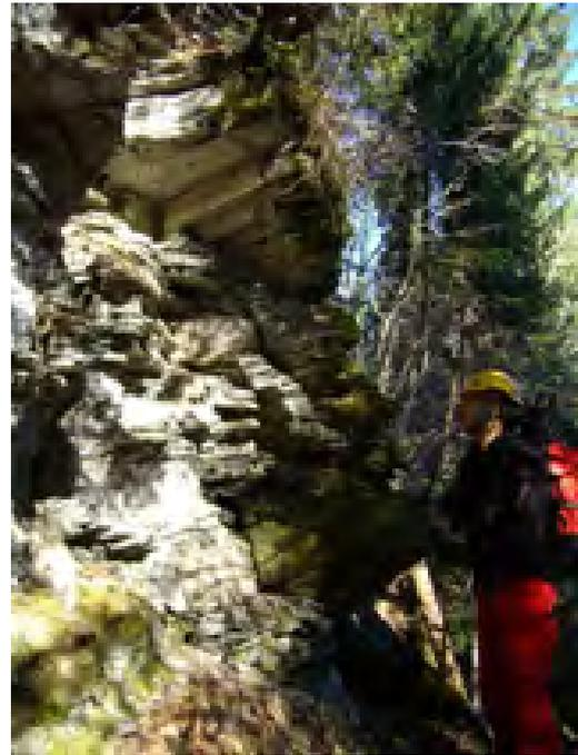
Le massif est fortement fracturé, ce qui permet l'individualisation de nombreux blocs d'un volume pouvant varier de quelques centaines de litres à plusieurs mètres cube.
