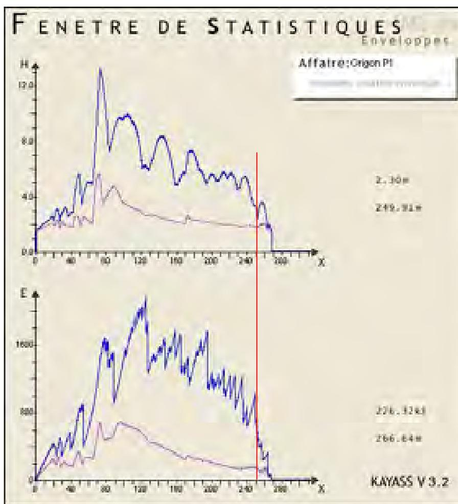
Courbes enveloppes des Hauteurs de passage des blocs.
