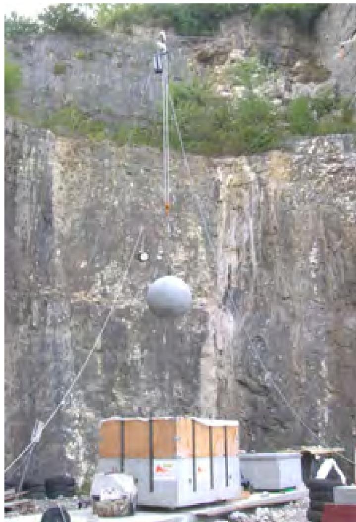
*Ci-dessus, vue sur le site de test. Les blocs peuvent chuter jusqu'à 15 m de hauteur.*
