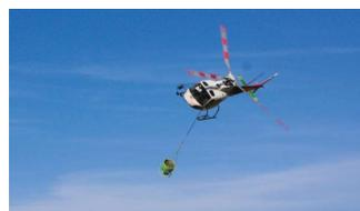
L'hélicoptère sera utilisé pour l'évacuation du matériel démonté et des coupes de bois. Il permettra en ligne la coulée des bétons et le montage des ouvrages de ligne.
