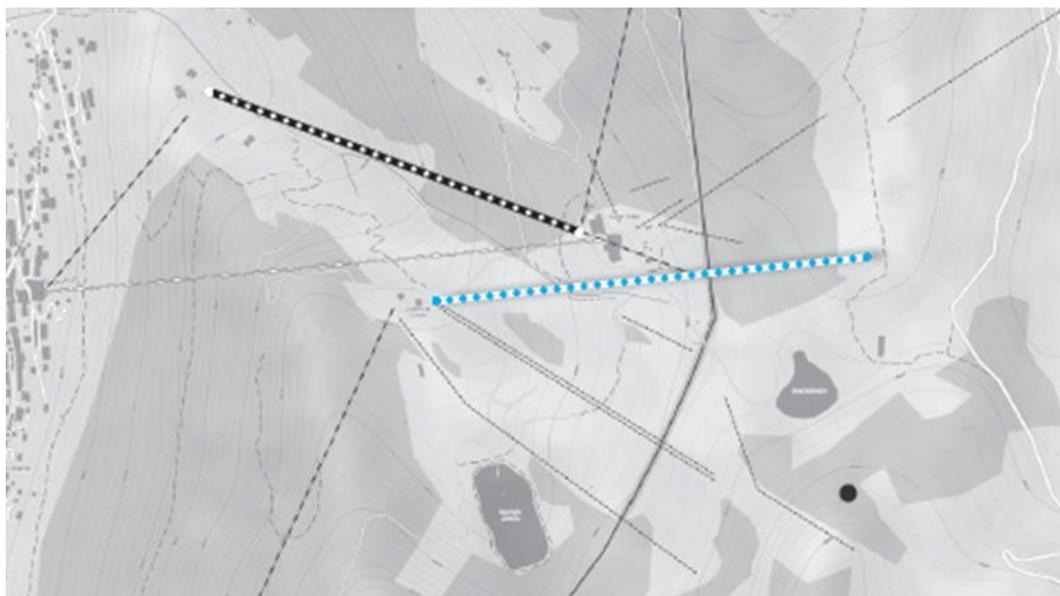
Figure 5 : Tracés de la variante 2. En noir, le raccourcissement de l'actuel TS de Conches et en bleu, la création d'une nouvelle installation (CIME, 2019).
